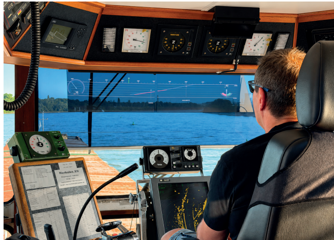
An Bord der „Herkules XII“ von HGK Shipping erhält der Schiffsführer über das Apprisify Smart-Window wichtige Informationen zu Route, Ruderlage und umliegenden Schiffen direkt im Sichtfeld
